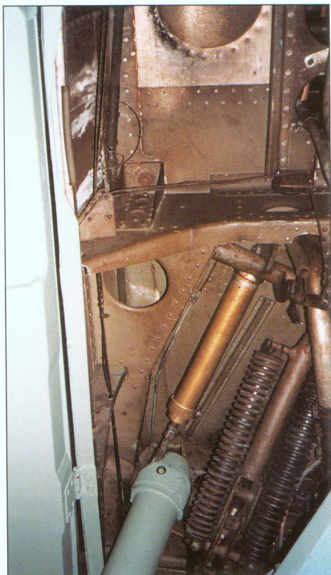
Dole: Levé podvozkové kolo - dvířka byla celodřevěné konstrukce a zavěšena na jednoduchých závěsech
