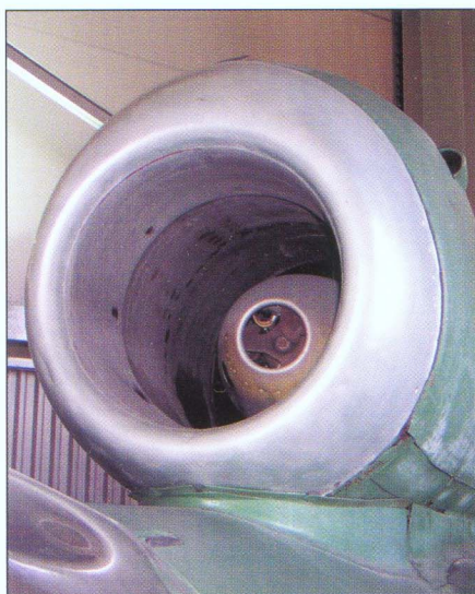
Nahoře: Lapač chladicího vzduchu ke generátoru motoru Top: The air intake for cooling the jet engine's electrical output generator
