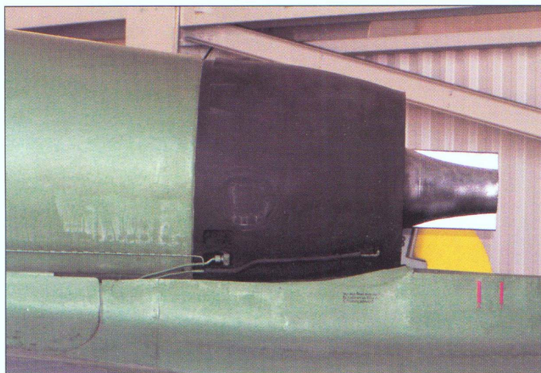
Vlevo a vpravo: Čelní prstenec motoru BMW 003 s kuželovým krytem startovacího motoru Riedel Left and right: The forward cowl of the BMW 003 engine, with the conical cover of the Riedel starter motor
