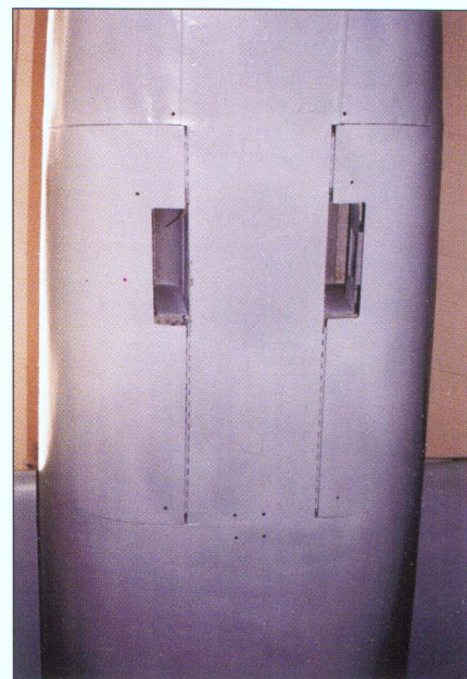
Otvory k odhozu prázdných nábojnic (fotografováno v IWM v Londýně) The ejection openings for spent cannon cartridges photographed in the IWM
