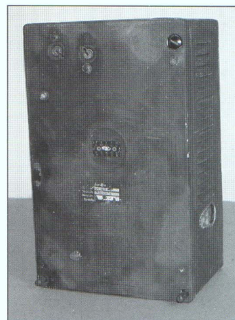
Dole: Identifikační zařízení FuG 25a - přední a zadní strana Bottom: The identification friend or foe (IFF) device FuG 25a - the front and the back side (J. Šilhánek)
