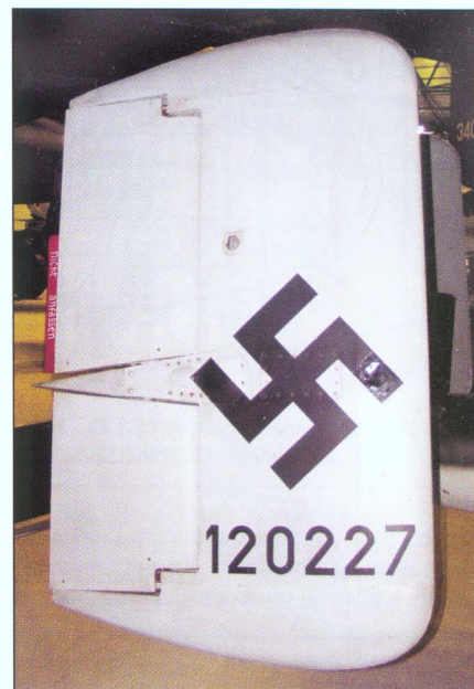
Dole: Ocasní kužel s neopotřebovanou ostruhou a s původním základním ochranným nátěrem ve VTM Lešany Bottom: The tail cone with an undamaged tailskid and with its original layer of protective primer paint at the VTM Lesany
