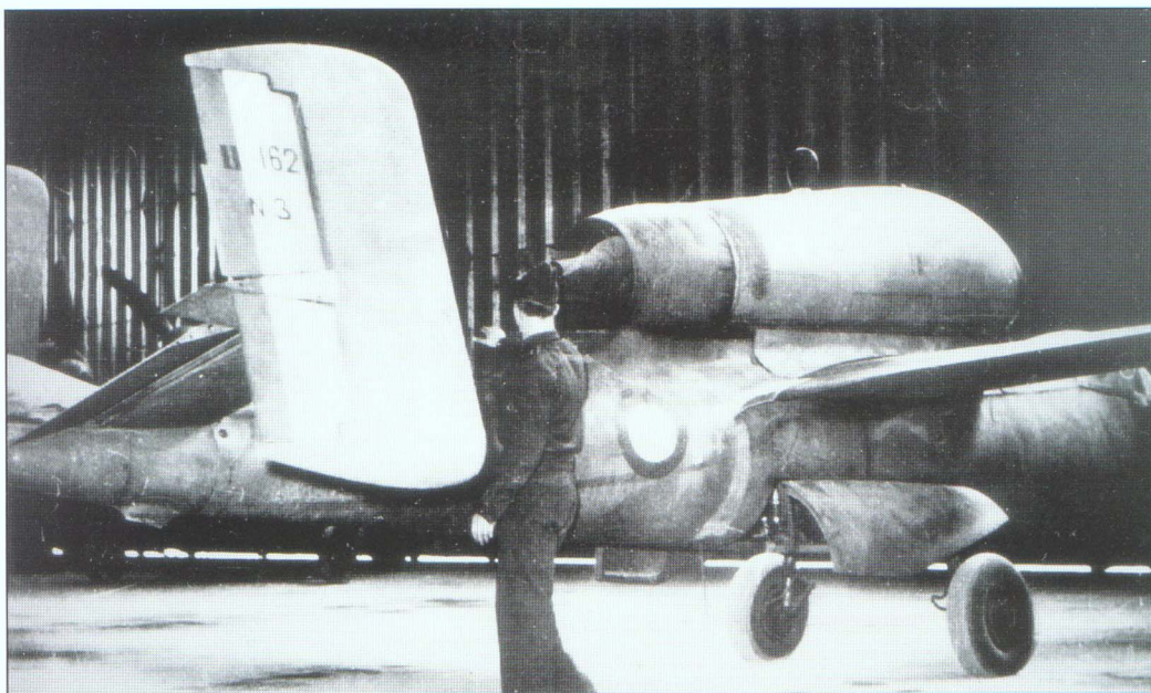
He 162A-2 v barvách francouzského letectva s číslem 3 na směrovém kormidle. Všimněte si značného opotřebení "ostruhy" pod zádí trupu (Sbírka M. Balouse)
