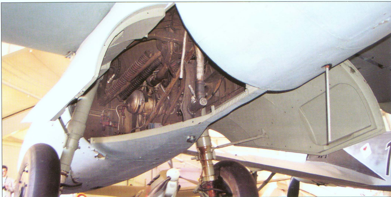
Levá noha hlavního podvozku a pohled do útrobu trupu. Všimněte si antény radiové soupravy FuG 25a
