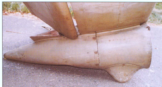
Dole: Ocasní kužel s neopotřebovanou ostruhou a s původním základním ochranným nátěrem ve VTM Lešany Bottom: The tail cone with an undamaged tailskid and with its original layer of protective primer paint at the VTM Lesany
